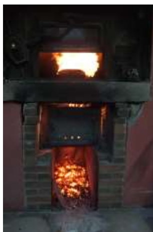
Du foyer les flammes sortent /gueulent dans une pièce en fonte qui s'appelle le « gueulard »
