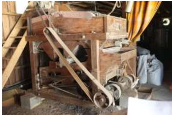
Trieur à Grains pour le nettoyage après la récolte et avant la mise en Silo, Chez Pierre (56)
