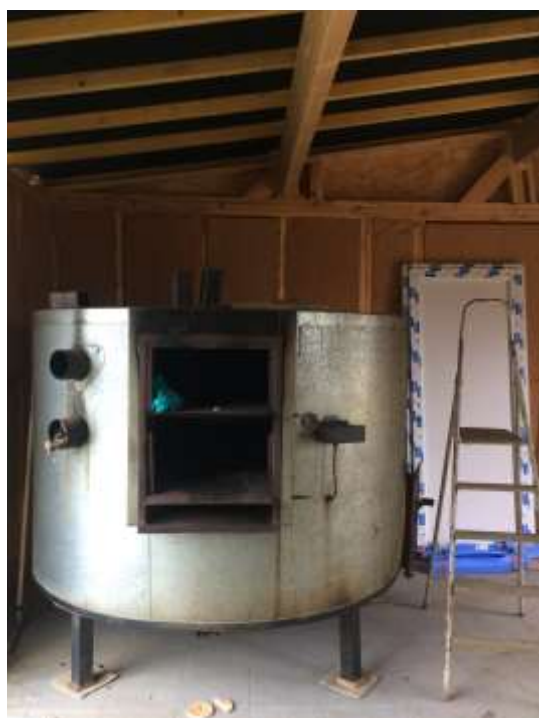
Le four Farmaconstruction ou « Chevet » Poids : 1,2 tonnes Capacités de pain : 2x30kg
